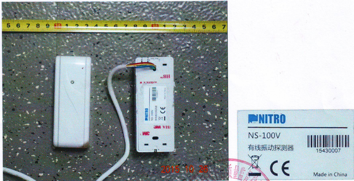
图一、NS-100V 振动入侵探测器外部结构及产品标记
